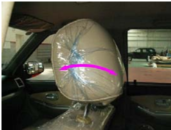
Рис. 19. Регулировка подголовника по углу наклона
