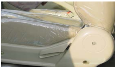
Рис. 17. Рукоятка регулировки угла наклона спинки сиденья
