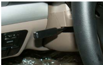
Рис. 22. Рукоятка регулировки угла наклона рулевой колонки
