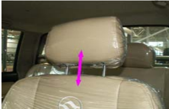
Рис. 18. Регулировка подголовника по высоте
