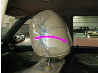
Рис. 20. Регулировка подголовника по углу наклона
