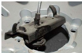
Рис. 73. Снятие колеса с захвата
