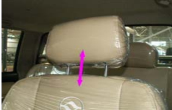
Рис. 19. Регулировка подголовника по высоте
